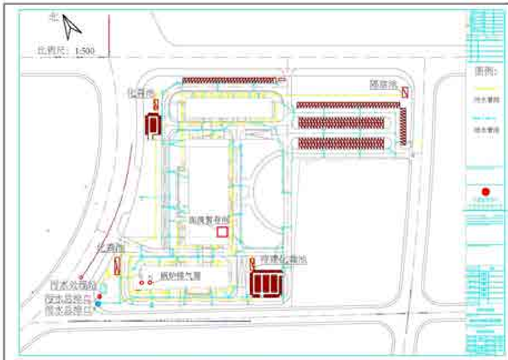
附图5 项目验收阶段内部雨、污排水管布置及环保设施布置图
