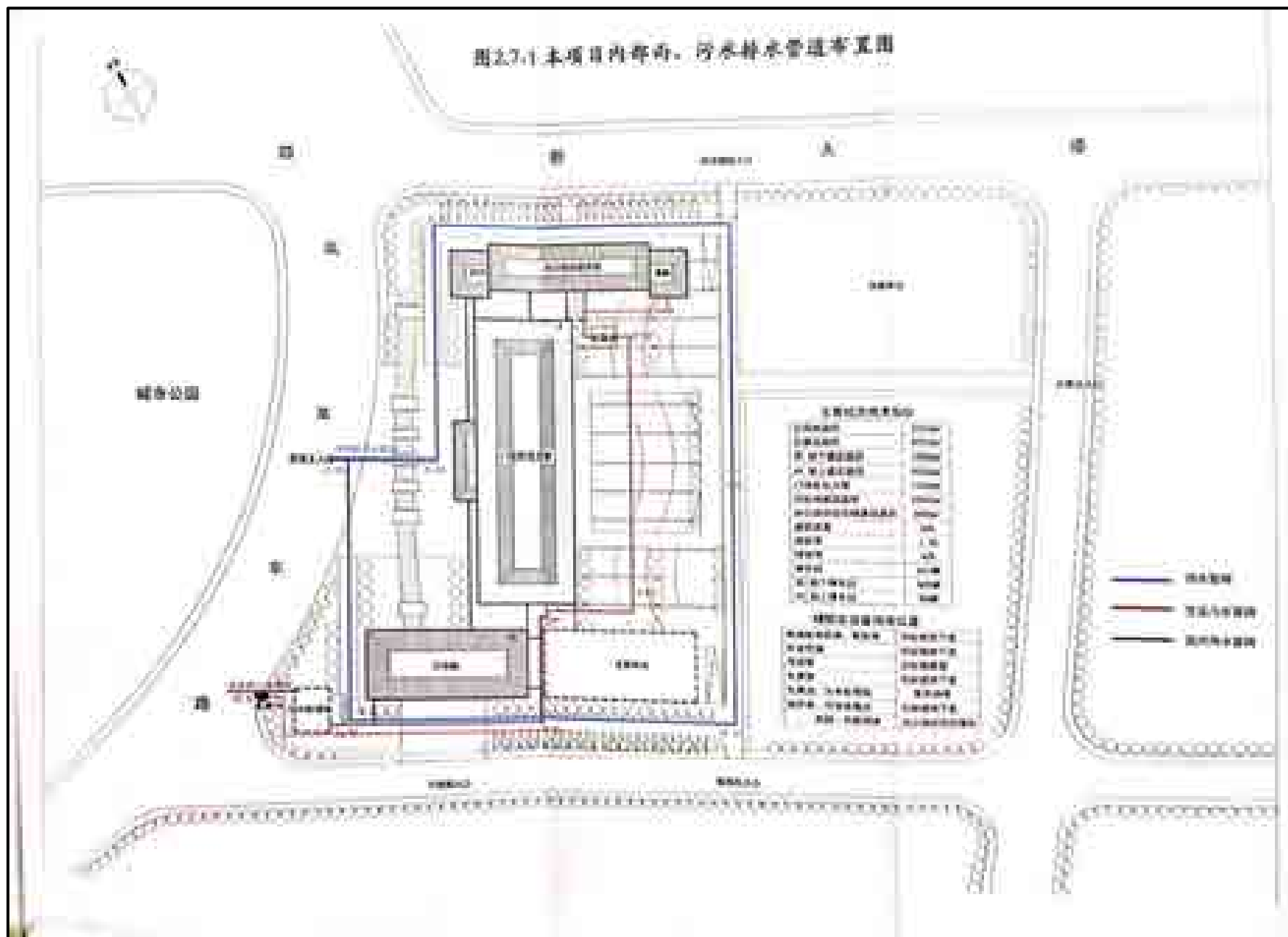
附图4 项目环评阶段内部雨、污水排水管布置图
