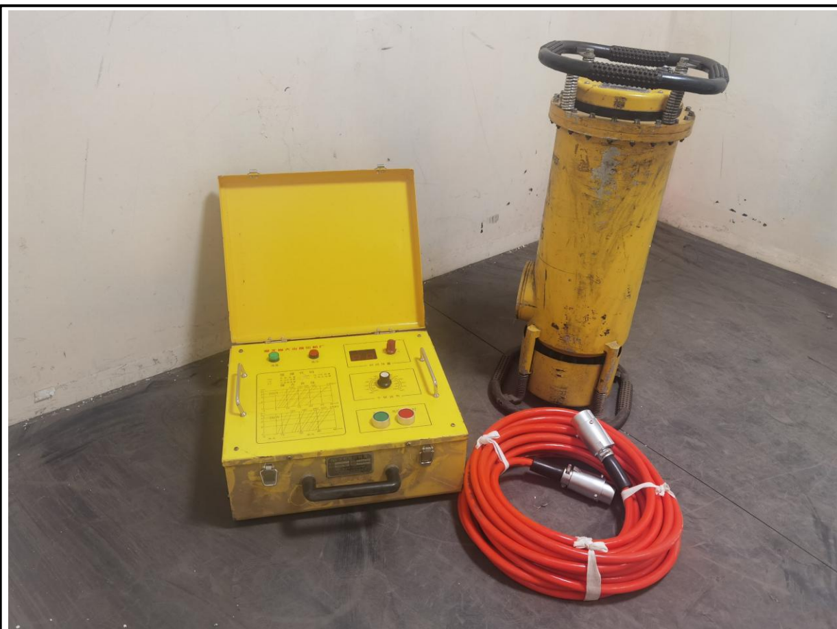
图 2.3-1 典型定向 X 射线探伤设备基本组成图
