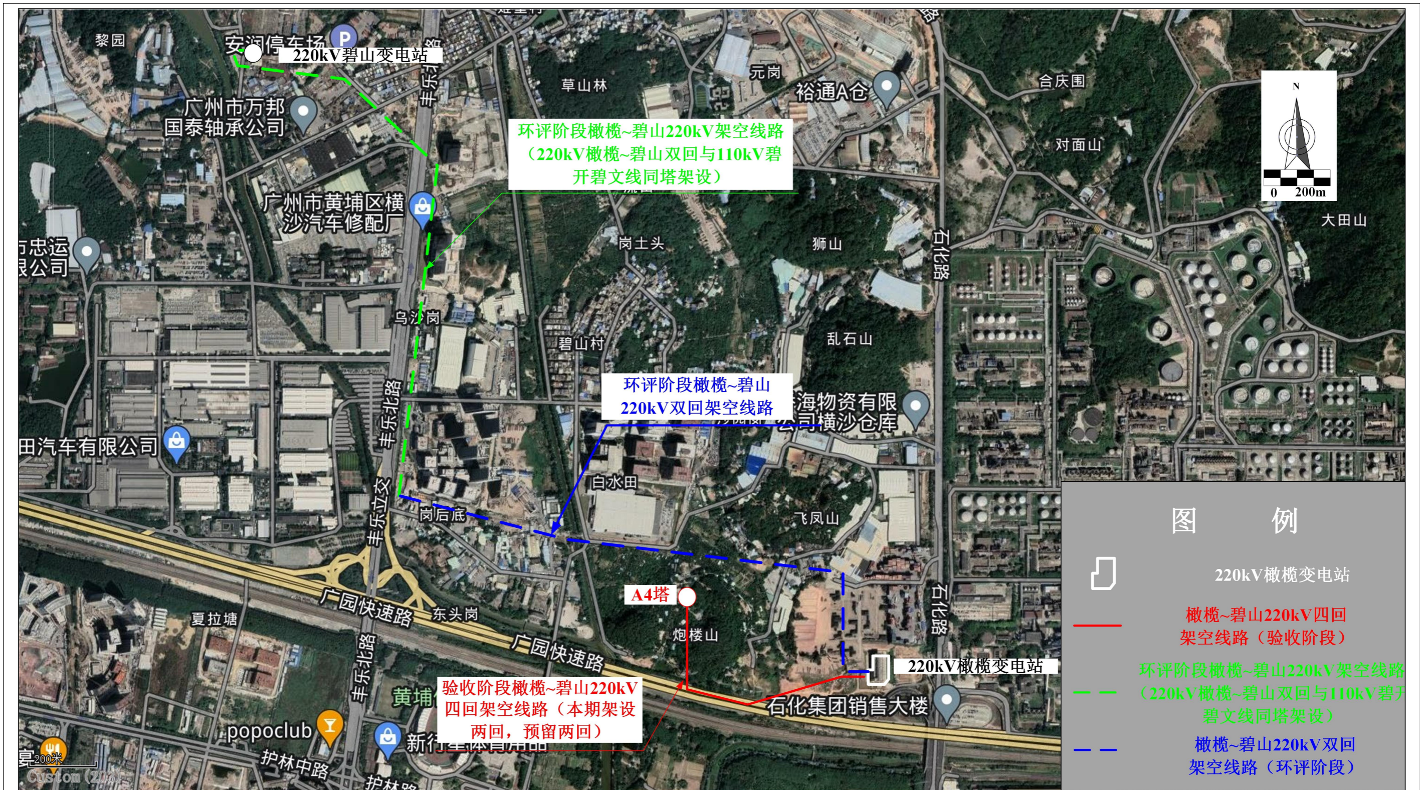
图4-11 橄欖~碧山220kV线路路径环评阶段与验收阶段对比图 (由于该线路未接通运行, 因此该线路不列入本次调查规模)
