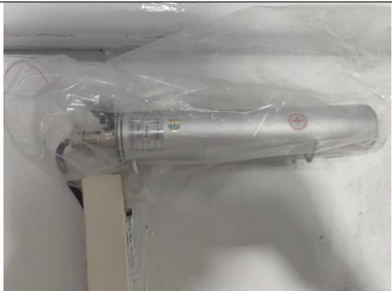
探伤室内固定式辐射报警仪探头
