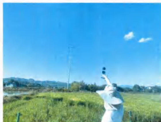
金亭~碧湖 \pi 入高溪 110kV 双回架空线路 声环境断面检测照片
