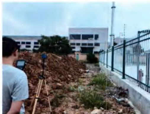
站址南侧电磁环境现状检测
