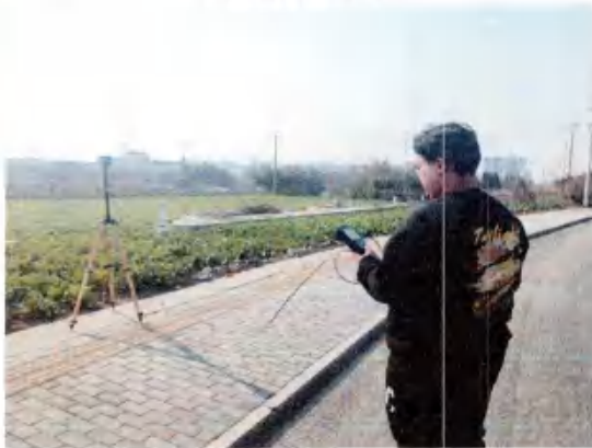
拟建陆家 110kV 变电站站址北侧电磁环境检测照片
