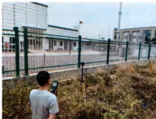
站址东侧电磁环境现状检测
