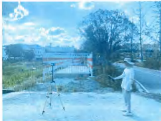
金亭~碧湖 \pi 入高溪变 110kV 双回电缆线路 电磁环境断面检测照片
