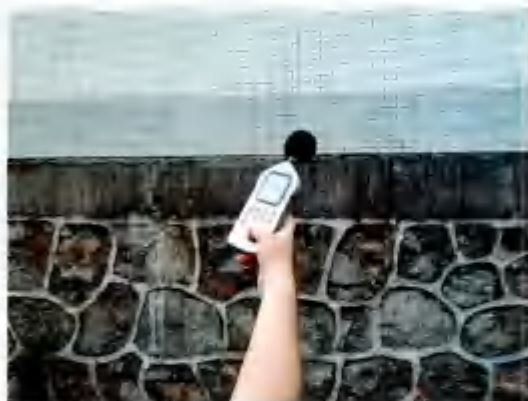
变电站西南侧围墙外声环境现状检测
