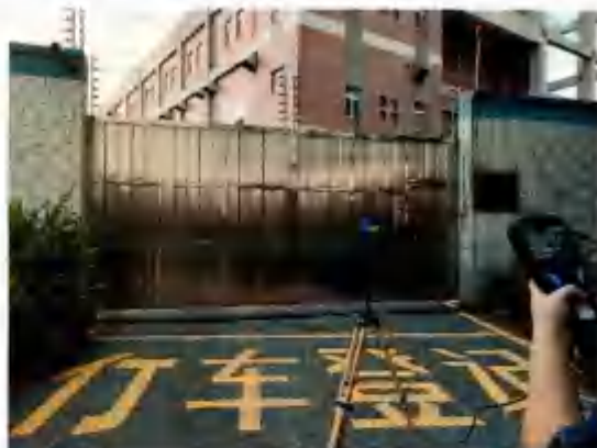
变电站西北侧围墙外电磁环境现状检测
