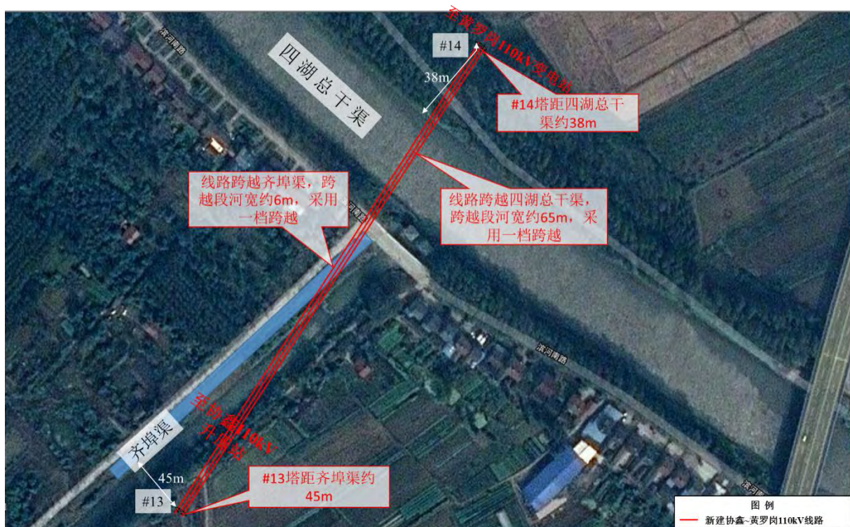
图 2-3 本工程 110kV 输电线路与齐埠渠、四湖总干渠相对位置关系示意图
