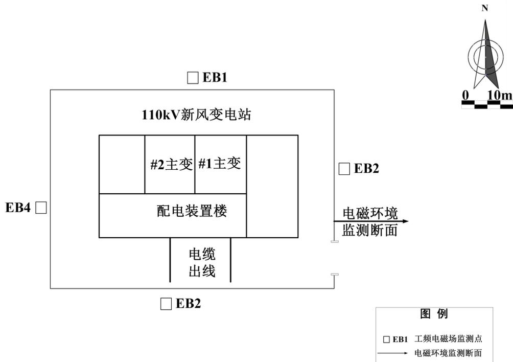
图 3-1 110kV 新风变电站监测点位示意图
