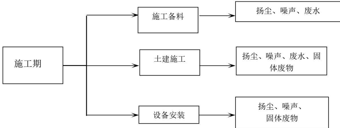
图 5-1 工程施工流程及产污环节图
